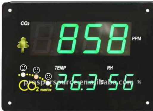
شكل (١٢) : جهاز لقياس ثاني أكسيد الكربون والرطوبة النسبية ودرجة الحرارة
